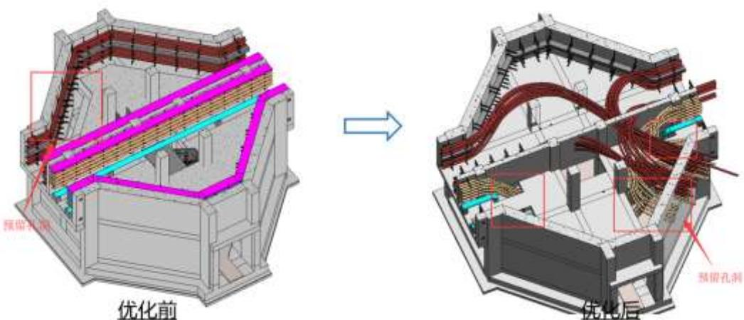
图 4-12 电力电缆管线排布优化前后截图
