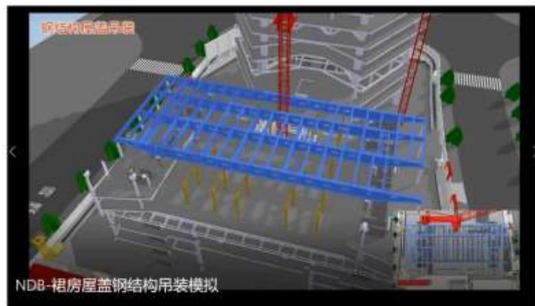
图 1-15 裙房屋盖钢结构吊装模拟
