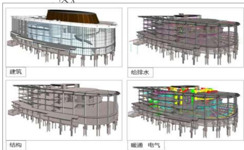
图 9-7 BIM 模型创建
