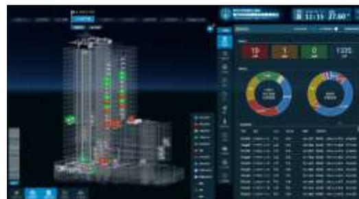
图 3-9 监测数据与 BIM 模型集成
