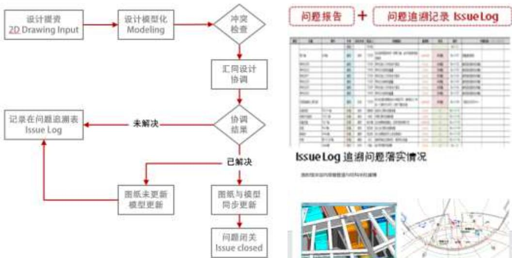
图 2-3 BIM 设计流程
