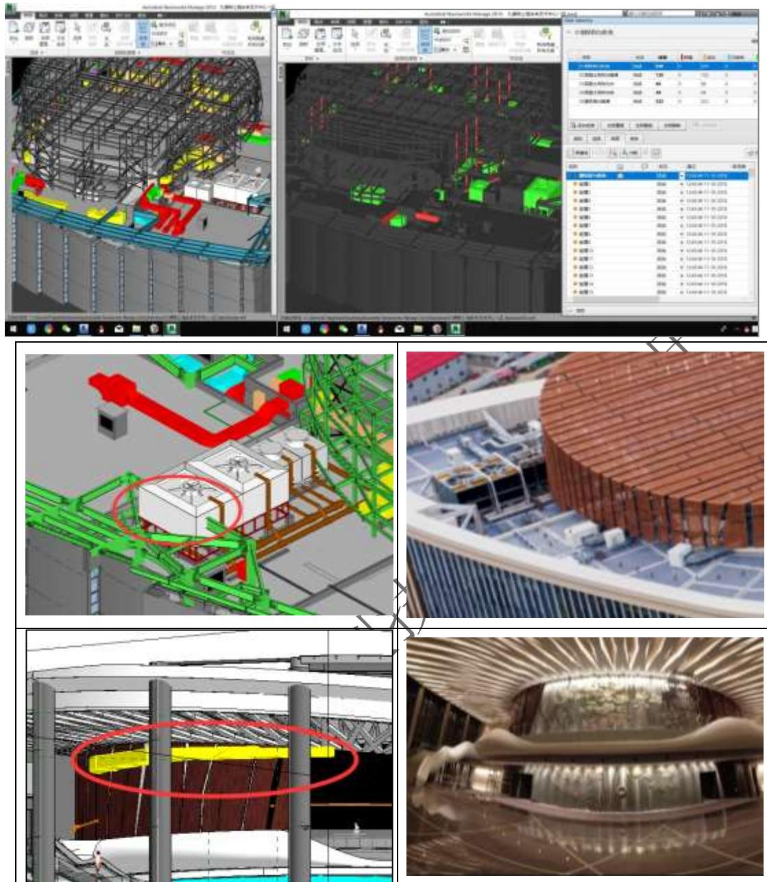
图 9-12 深化设计二次碰撞检测
