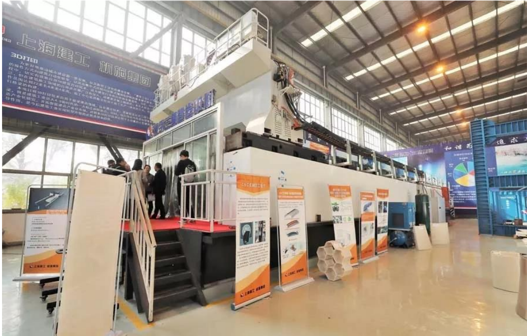
图 3-45 龙门架复合 3D 打印机器人系统
