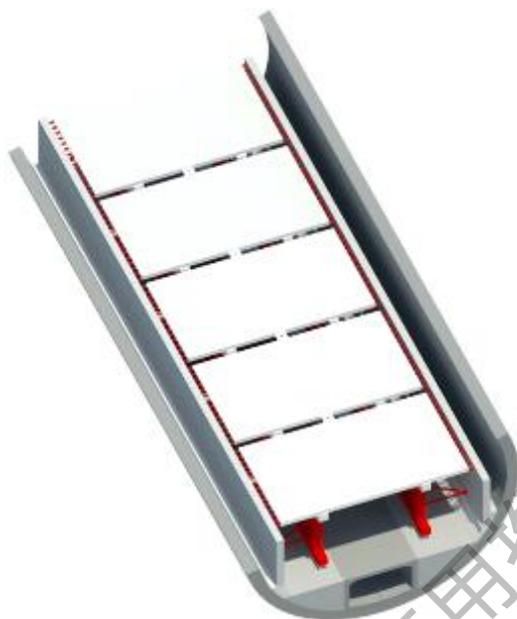
图 23 整体自移动式龙门钢模架
