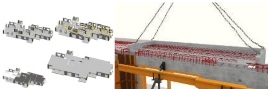
图 25 预制构件安装模拟
