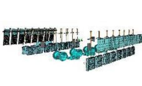
图 4 泵室水机、金结及电气初步设计 BIM 模型
