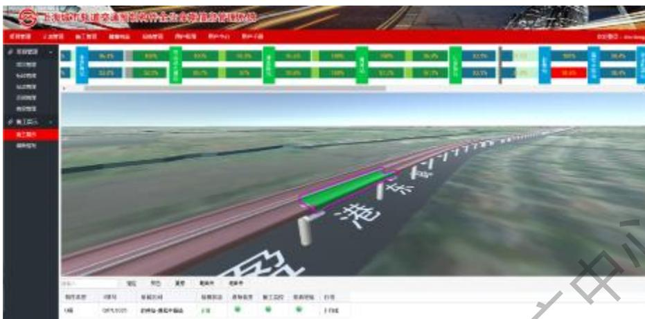
图 51 预制 U 型梁 BIM 模型界面
