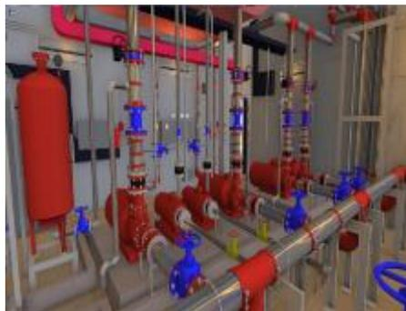
图 25 消防泵房施工深化模型
