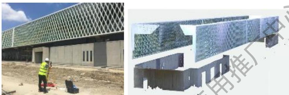
图 29 高架车站外立面点云数据获取及点云模型生成
