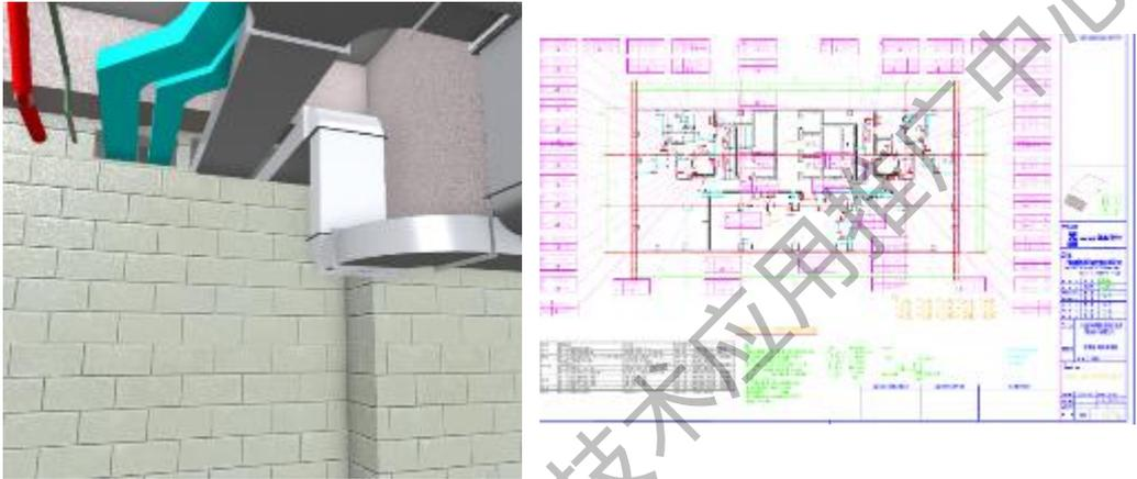
图 14 2 号楼标准层管综优化节点及三维出图
