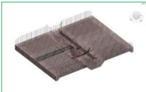
图 22 底板钢筋建模
