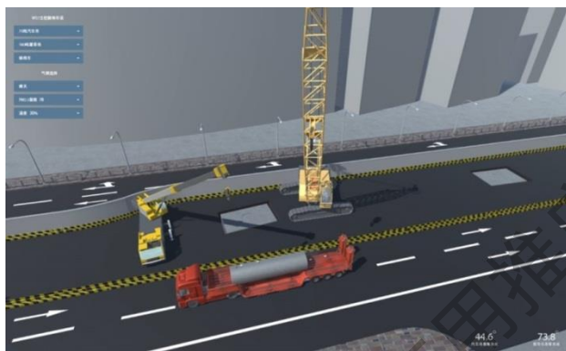
图 19 立柱翻转吊装模拟
